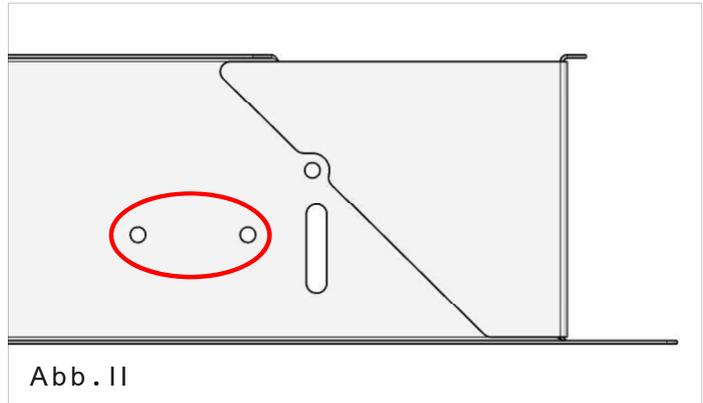
1. Noch vor dem Einsetzen der Tür sind die Anschlagwinkel (K) mit je zwei Schrauben und Muttern oben und unten am Rahmen anzubringen. (Position Schrauben siehe **Abb. II**).
