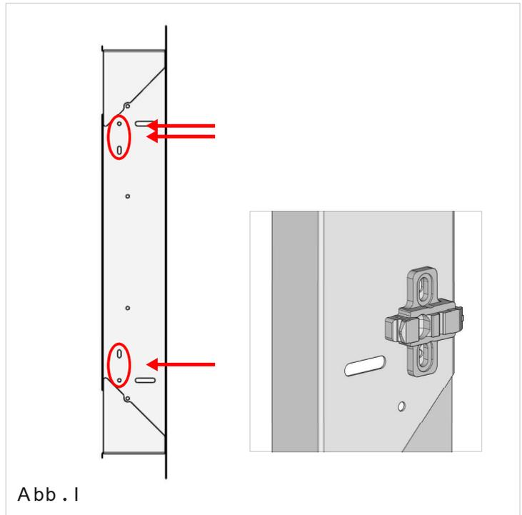
1. Die Kreuzmontageplatten werden mit zwei Schrauben (O) und Muttern (P) am Rahmen befestigt. (Position der Schrauben siehe **Abb . I**)
