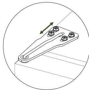
Die Befestigungen der Türen verfügen über Toleranzen bzw. Langlöcher, die eine Ausrichtung ermöglichen.
