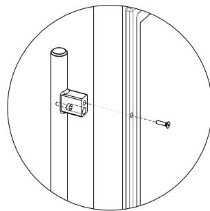
Befestige den Griff an den vorgebohrten Löchern an der Rückseite der Tür unter Verwendung der mitgelieferten Schrauben. Stell sicher, dass das Dichtungsgummi nach der Montage wieder in die vorgesehene Position zurückgeschoben wird und dabei nicht beschädigt wird.
