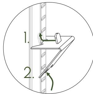
Befestige die Halteklemmen an den Halteschienen, indem du die obere Nase der Klammer zunächst in die Öffnung der Schiene kippst. Auf dieser Höhe wird später der Regalboden platziert.
