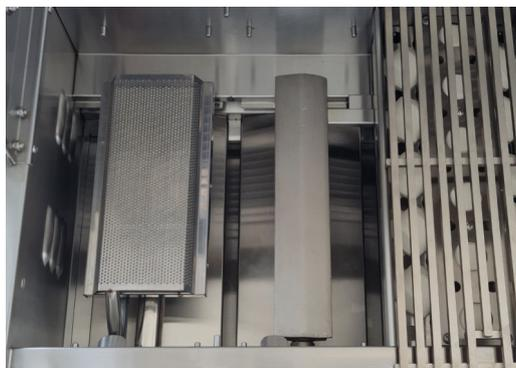
6. Lege nun wieder das Temperaturtrennblech, anschließend den Keramikflammenabweiser über dem 2. Brenner und beide Grillroste ein. Der Keramikflammenabweiser und die Zündbrücke dürfen nicht erneut über dem Infrarotbrenner eingesetzt werden.
